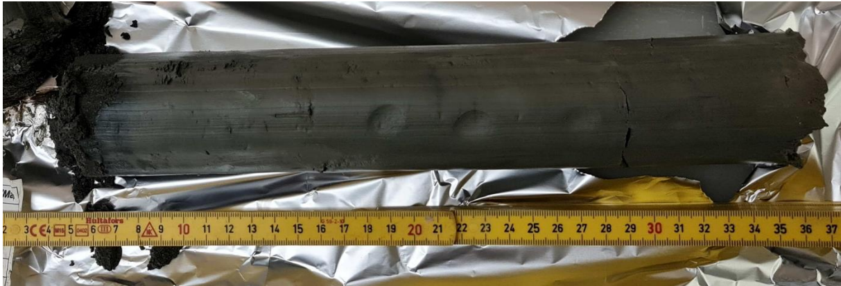
Kjerneprøven mellom 0,1-0,5 m. Toppen av kjernen er til venstre
