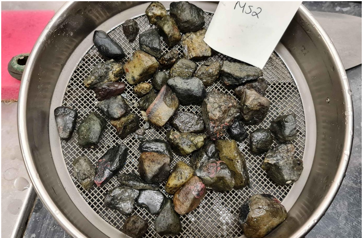
Vasket grovt sedimentmateriale, med minimal begroing og mørk misfarging
