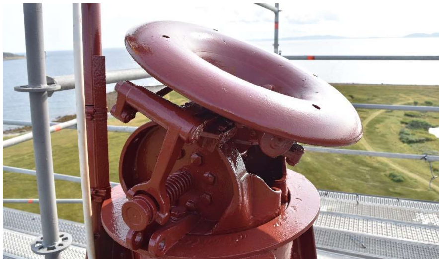
Figur 17: Toppen av forankringsmekanismen - en trakt for å føre fortøyningen ned til bakken. Mekanismen er roterbar og kan endre vinkel. Foto: FFK.
