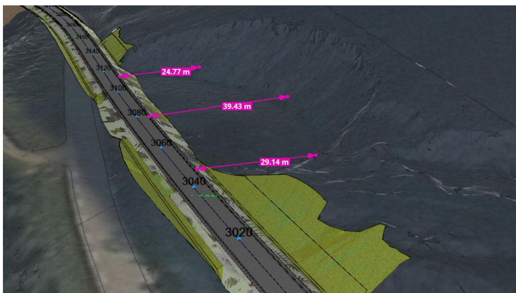
Figur 17-1: Vegomlegging ved massetaket nær Blåberget, cirka profil 3020-3140
