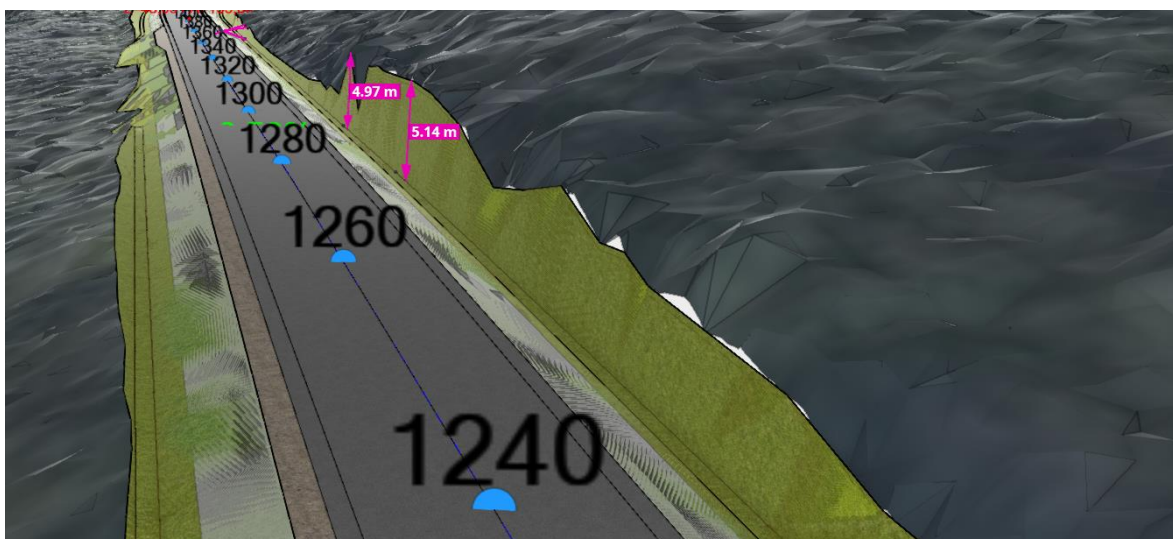
Figur 14-4: Bergskjæringer mellom profil 1220 til 1320.
