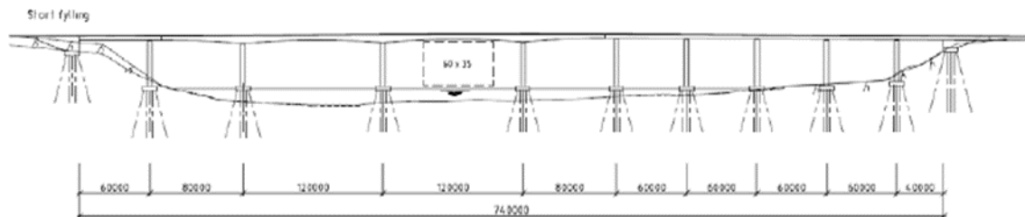
Figur 5 Tegning Samvirkebru 740 meter
