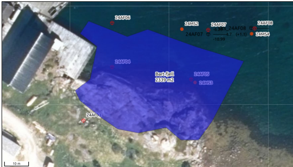
Figur 5: Notert berg i dagen av GeoNord i forbindelse med grunnundersøkelser (markert med blått)
