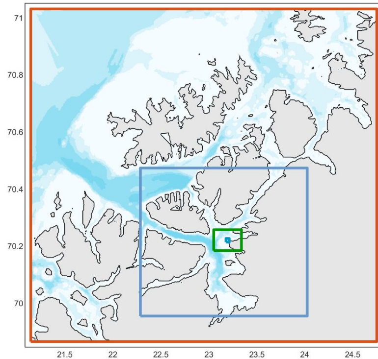
Figur 4: Beregningsdommene. Blå, grønn og lys blå firkant markerer beregningsgitter med økt oppløsning inn mot det planlagte tiltaksområde. Akser i geografiske koordinater
