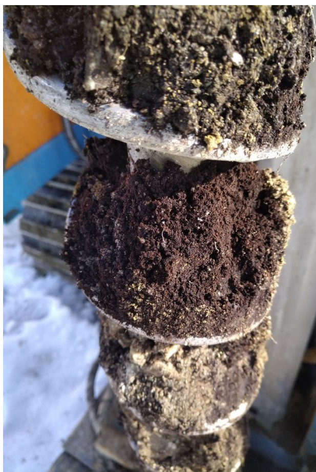
mørk torvjord mellom 0,2-0,4 m
